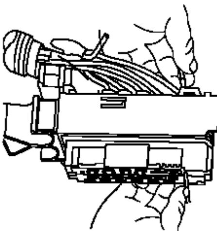
7.将J-38125-12A工具压入被拆卸端子的释放孔内，小心将导线从连接器的背部拉出。从连接器中拔出端子时，切勿强行用力。
