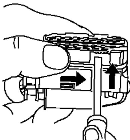
5.用小号平刃工具推压鼻端固定件侧面，同时用拇指向前推鼻端。由此松开端子定位器 (TPA)。
