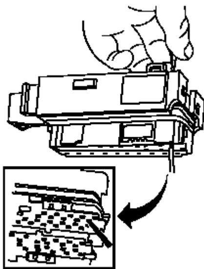
6.将J-38125-12A工具插入相应的端子释放孔中。释放孔位于连接器的其中一半上，是位于中央的2排孔。
